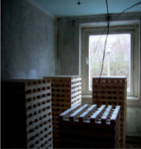
Abb. B6: Erhebliche Brandlast in einem der Brandräume: 475 kg Holz und 50 l Isopropanol.
