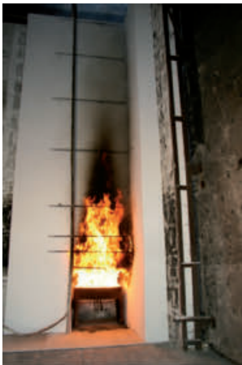
Abb. B4: Fassadenprüfstand gemäß DIBt-Zulassungsgrundsätzen und Entwurf DIN 4102-20. Die Brandprüfung des gesamten WDVS-Systems erfolgt im Originalmaßstab in Eckanordnung (Breite Rückwand 3,0 m, Breite Eckwand 1,5 m, Höhe 6,0 m).
