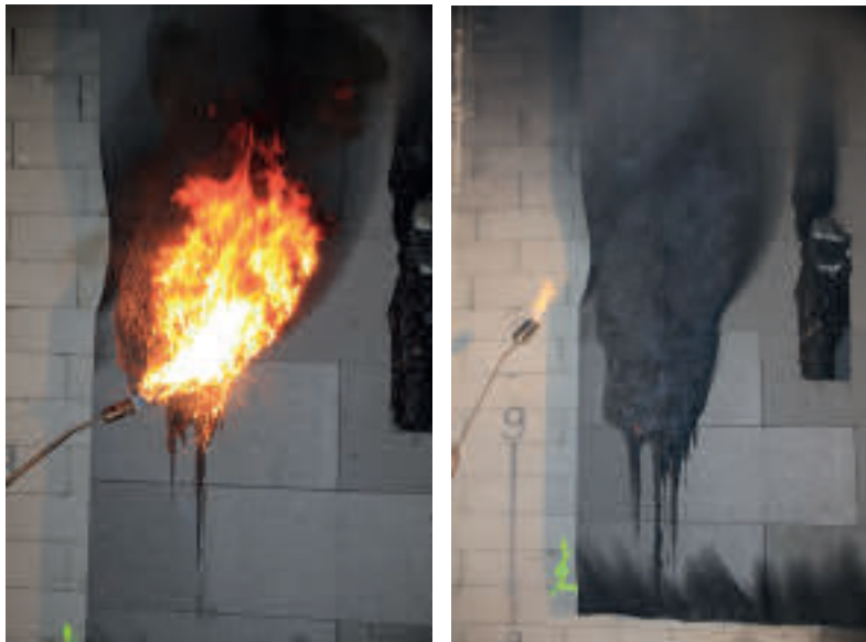
Abb. 54-55: Die Beflammung von unverputzten EPS-Dämmplatten mit einem 80-kW-Gasbrenner führt zu einem lokal begrenzten Abschmelzen, nicht jedoch zum dauerhaften selbständigen Weiterbrennen.
