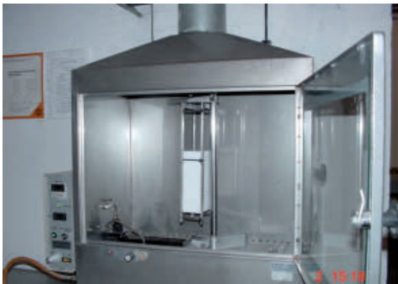
Abb. B1: Brennkasten mit eingebauter Probe. Es wird eine plane Probe mit einer Breite von 9 cm und einer Länge von 19 bzw. 23 cm geprüft.
