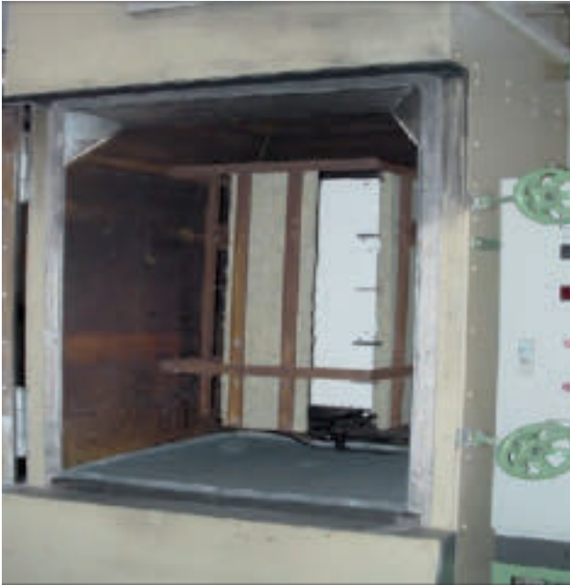
Abb. B2: Brandschacht mit eingebautem Probenkorb. Beim Brandschachttest werden vier schachtförmig angeordnete Proben mit einer Breite von 19 cm und einer Länge von 100 cm geprüft.
