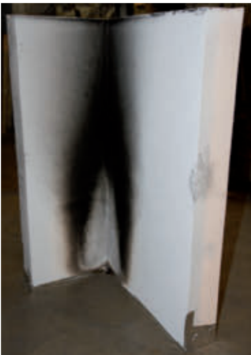
Abb. B3: Bei der Brandprüfung im SBI-Prüfstand wird ein Prüfkörper in Eckanordnung geprüft. Die Schenkel sind 0,5 m und 1,0 m lang bei einer Höhe von 1,5 m.
