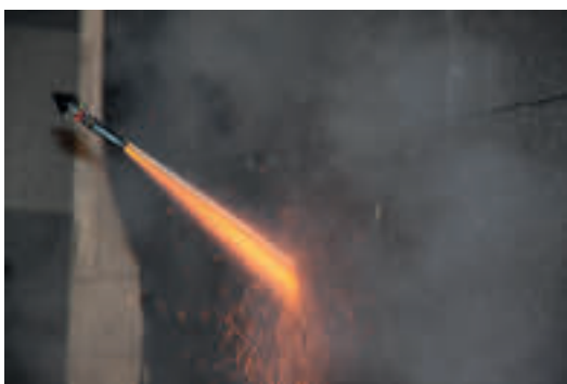
Abb. 52-53: Schwerentflammbare EPS-Dämmplatten werden durch Silvesterraketen nicht entzündet.
