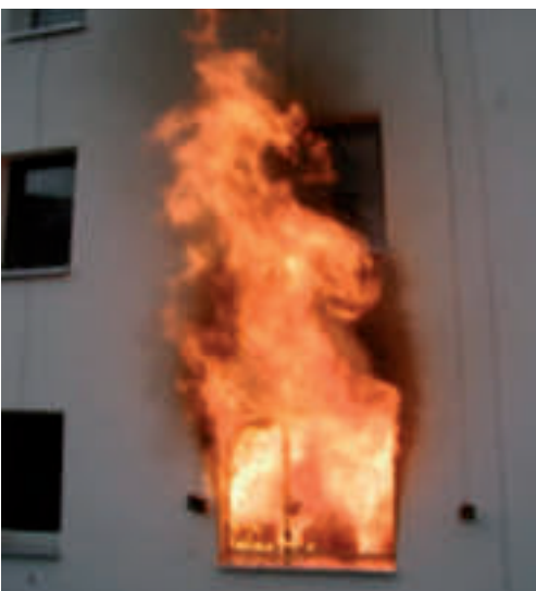
Abb. B8: Zum flash-over (d. h. Flammenausstritt aus der Fensteröffnung) kam es nach 5 Minuten. Die maximale Flammenhöhe betrug 4 m über dem Sturz.
